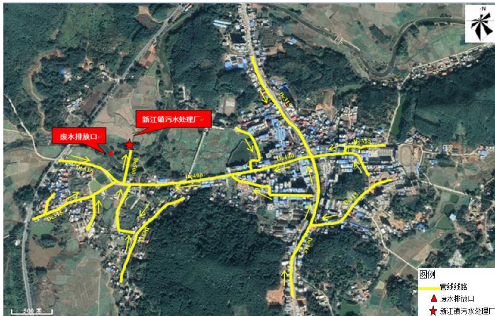
图 3 新江镇污水处理厂配套管网示意图
