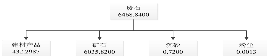
图7 硫元素平衡图 (t/a)
