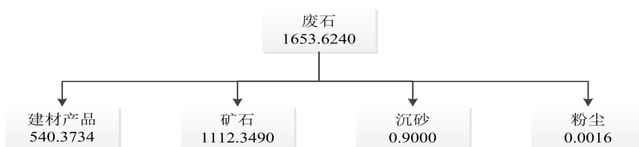
图5 锌元素平衡图 (t/a)
