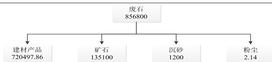
图4 总物料平衡图 (t/a)
