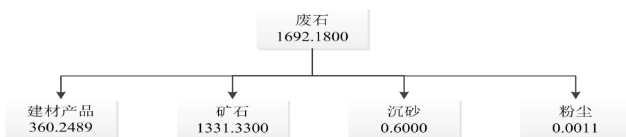
图6 铅元素平衡图 (t/a)
