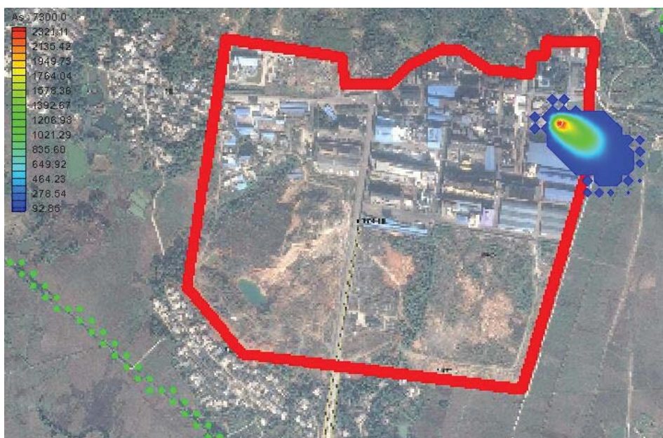
图 5.3.4-9 污酸调节池泄漏 7300 天时 As 污染晕变化图
