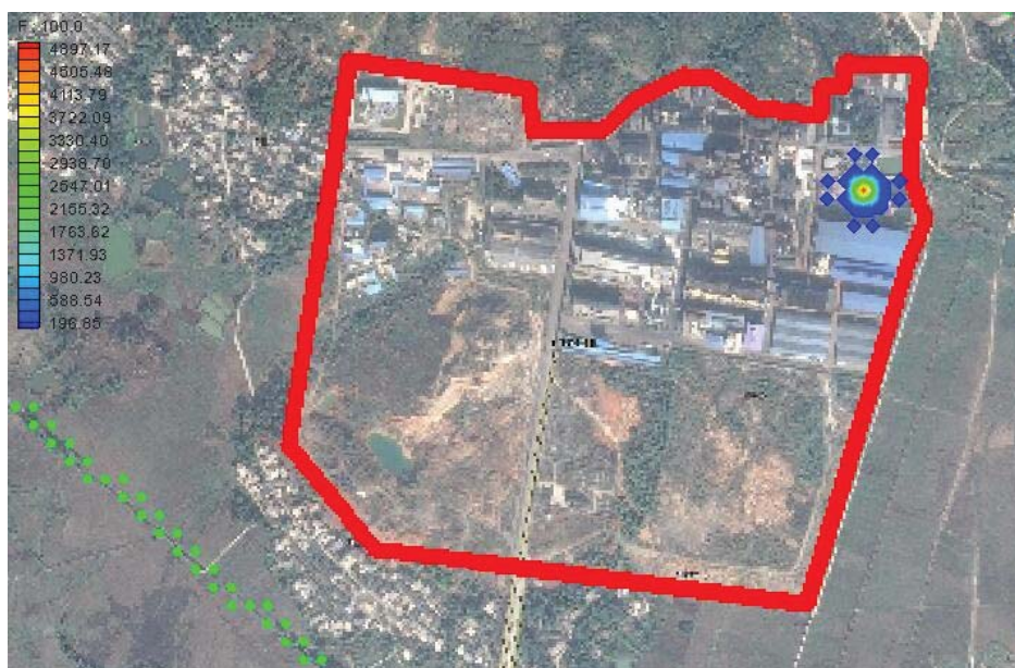
图 5.3.4-4 污酸调节池泄漏 100 天时 F 污染晕变化图
