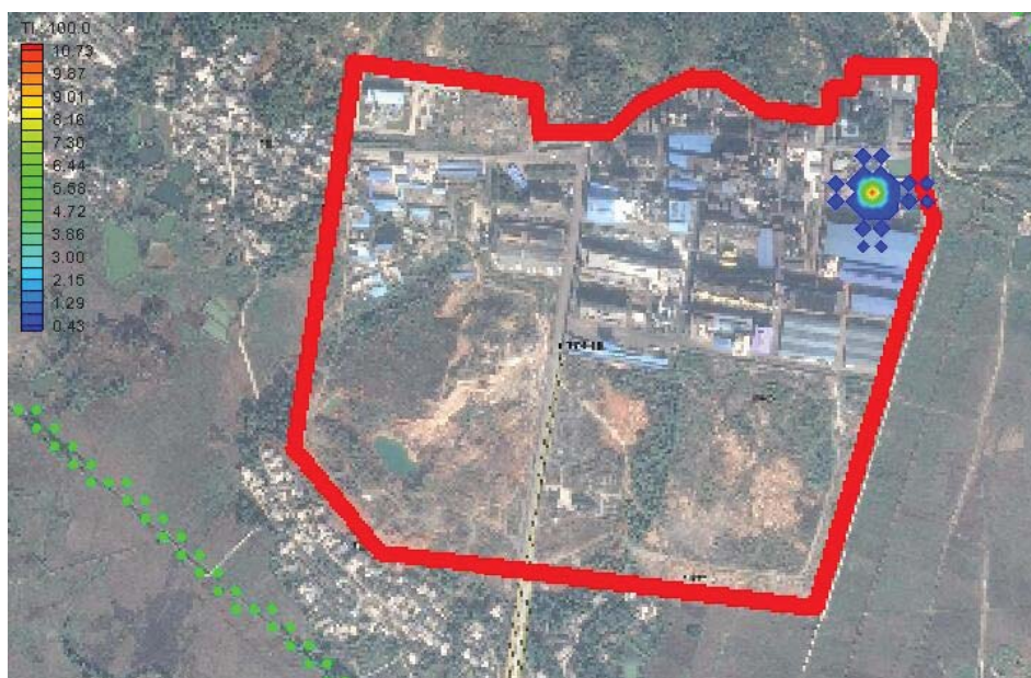
图 5.3.4-10 污酸调节池泄漏 100 天时 Ti 污染晕变化图
