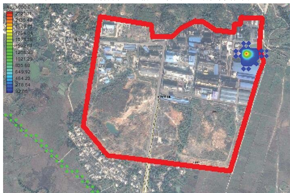
图 5.3.4-8 污酸调节池泄漏 1000 天时 As 污染晕变化图
