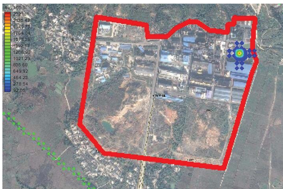
图 5.3.4-7 污酸调节池泄漏 100 天时 As 污染晕变化图
