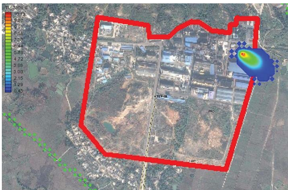
图 5.3.4-12 污酸调节池泄漏 7300 天时 TI 污染晕变化图
