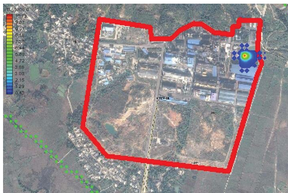
图 5.3.4-11 污酸调节池泄漏 1000 天时 TI 污染晕变化图
