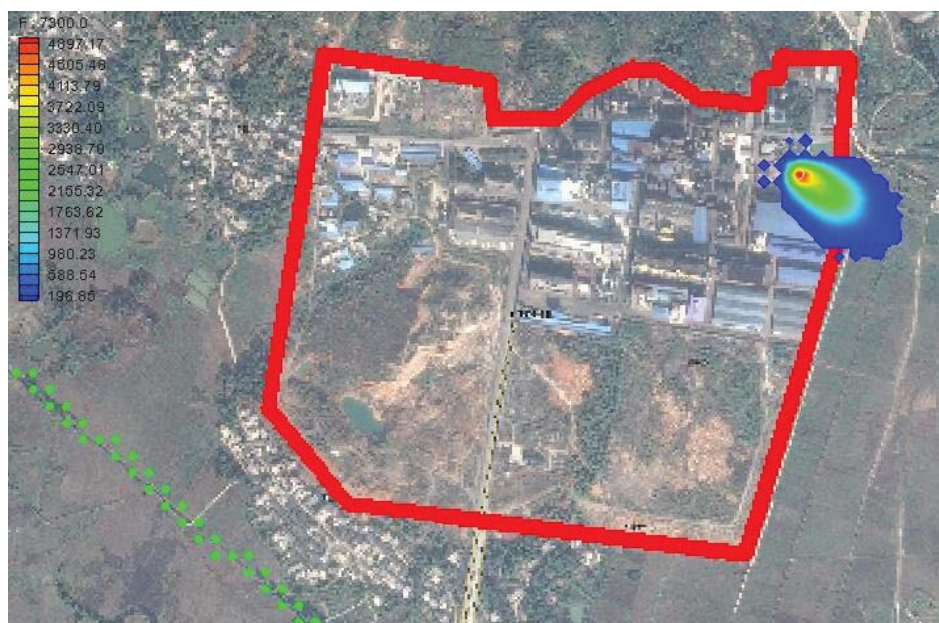
图 5.3.4-6 污酸调节池泄漏 7300 天时 F 污染晕变化图
