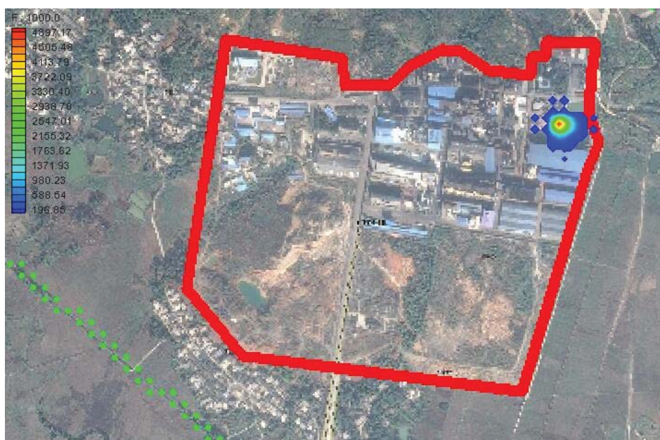
图 5.3.4-5 污酸调节池泄漏 1000 天时 F 污染晕变化图
