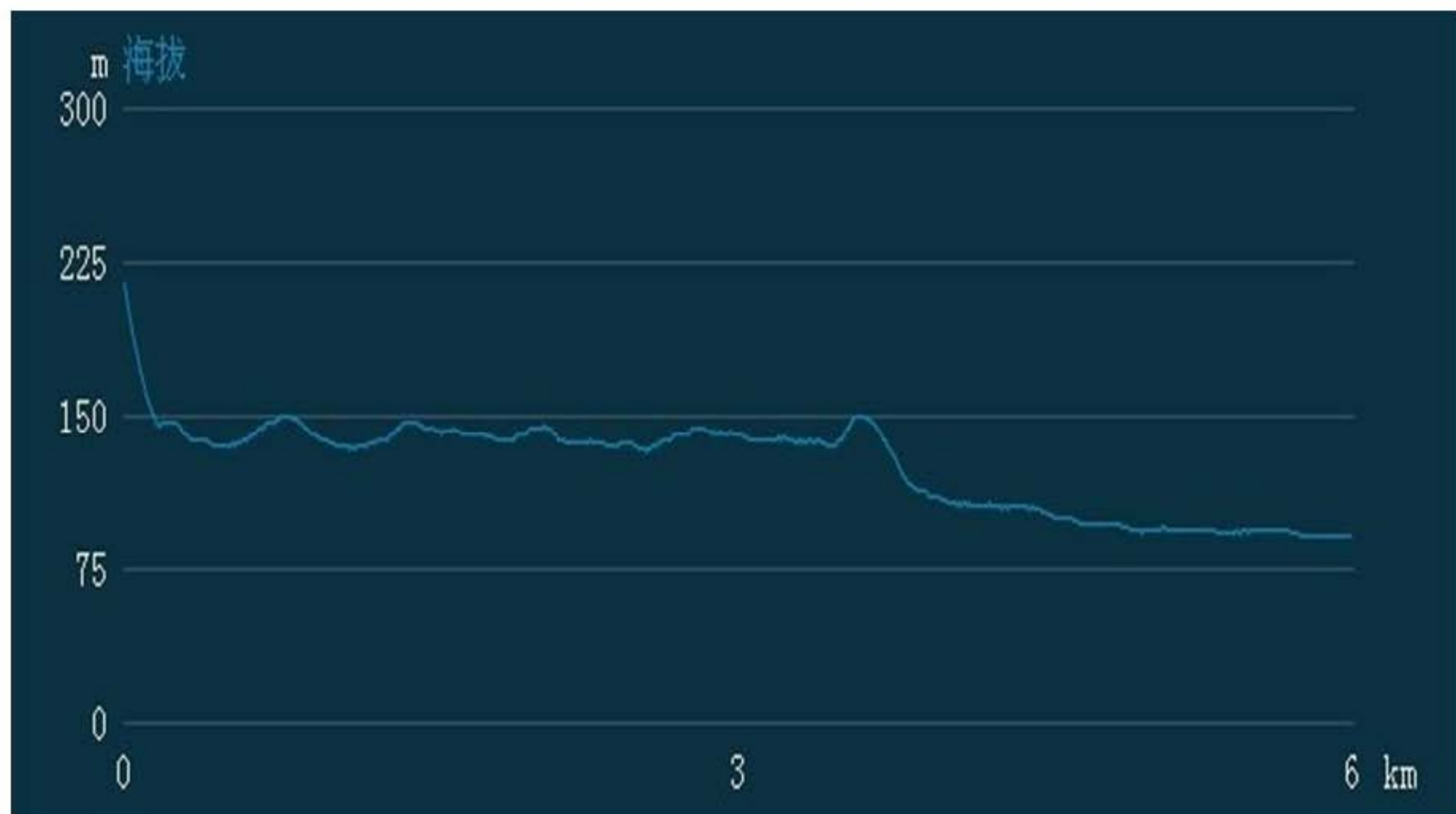
图 2 管线纵向剖面图
