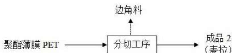
(a) 铝箔麦拉的生产工艺及排污环节
