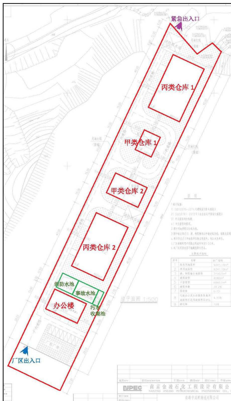
图3 项目总平面布置图
