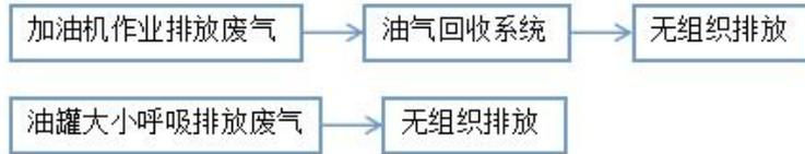
图 3-2 废气处理流程示意图
