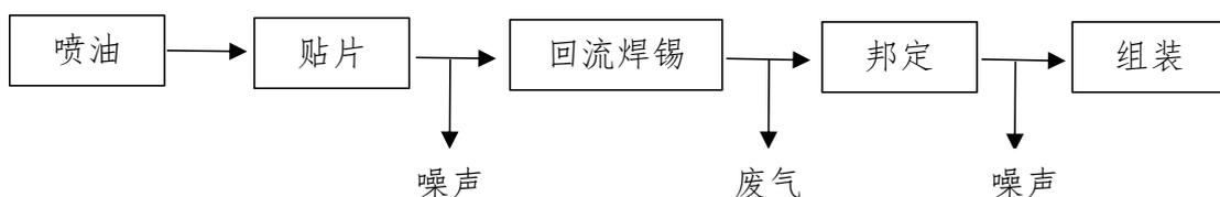
图 4-6 主要工序流程及排污节点图
