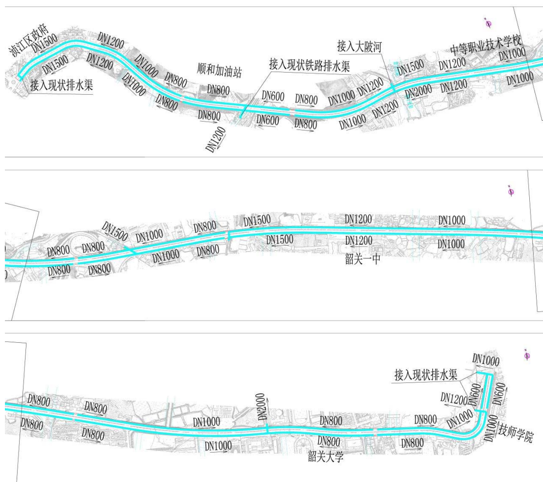
图 4.6-1 雨水管线规划图
