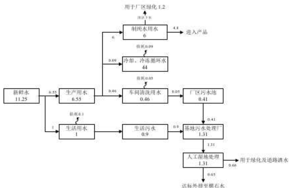
图 3-6 项目二期水平衡图 (单位:  $m^3/d$ )
