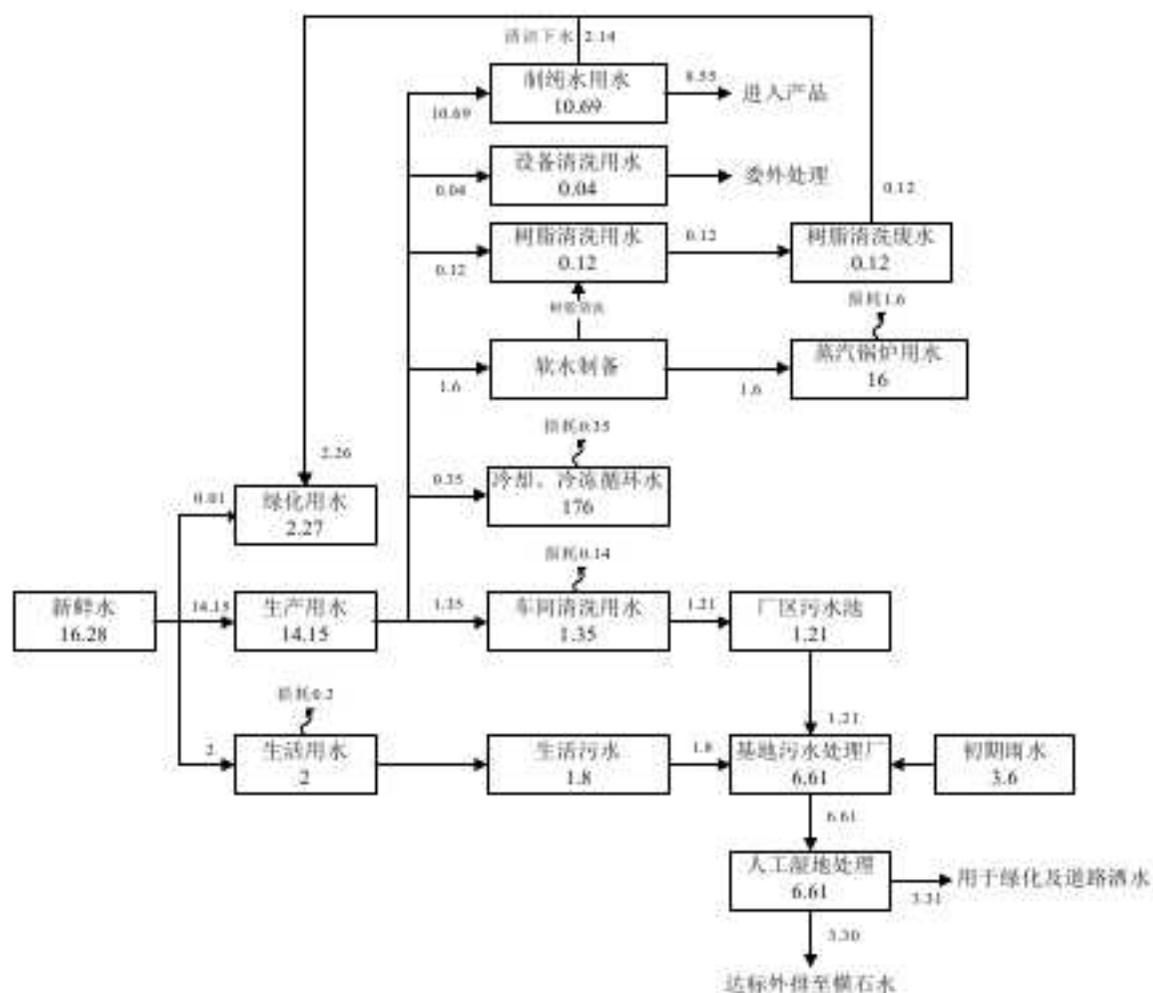
图 3-7 项目总水平衡图 (单位:  $m^3/d$ )
