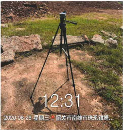
噪声现场检测图
