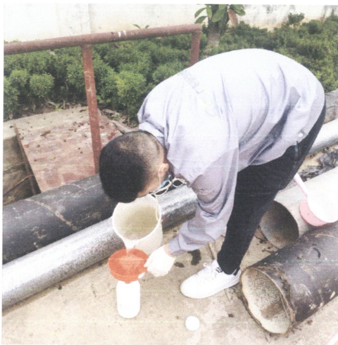
废水进水口采样
