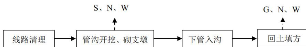
图 5-1 管道施工工艺及产污节点图
