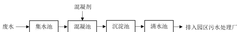
图 26 项目污水池预处理工艺流程图
