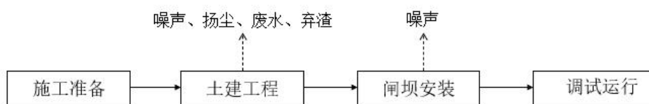
图 3 挡河水陂施工期工艺流程及产污节点图
