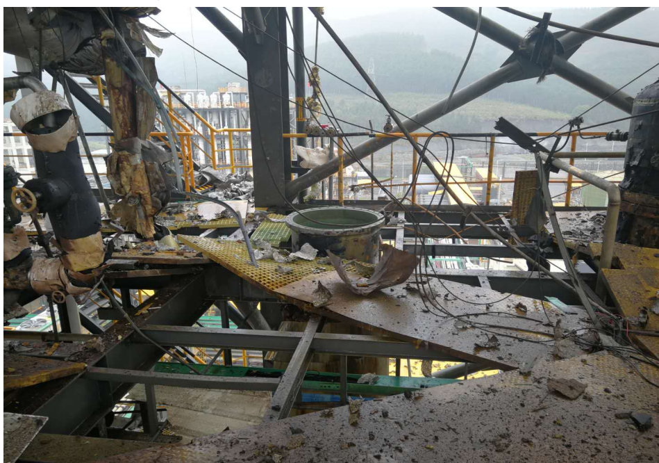
图 11 爆炸后的氯化氢分离塔（九层）
