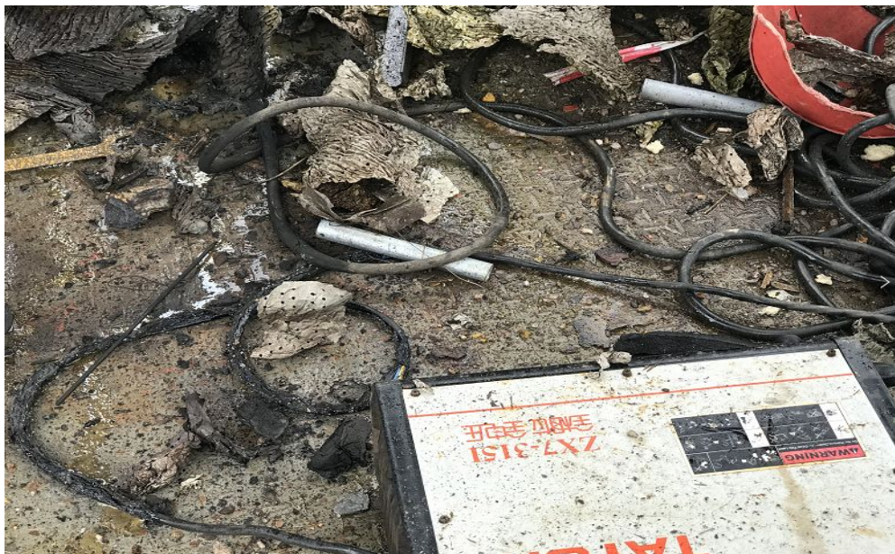
图 15 装置十层平台上面遗留电焊机
