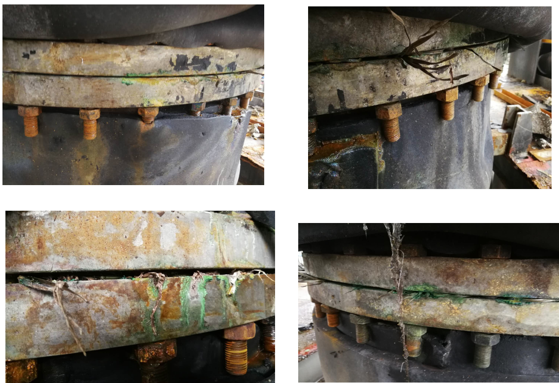
图 8 氯化氢分离塔 T21101 筒体法兰金属缠绕垫穿刺
