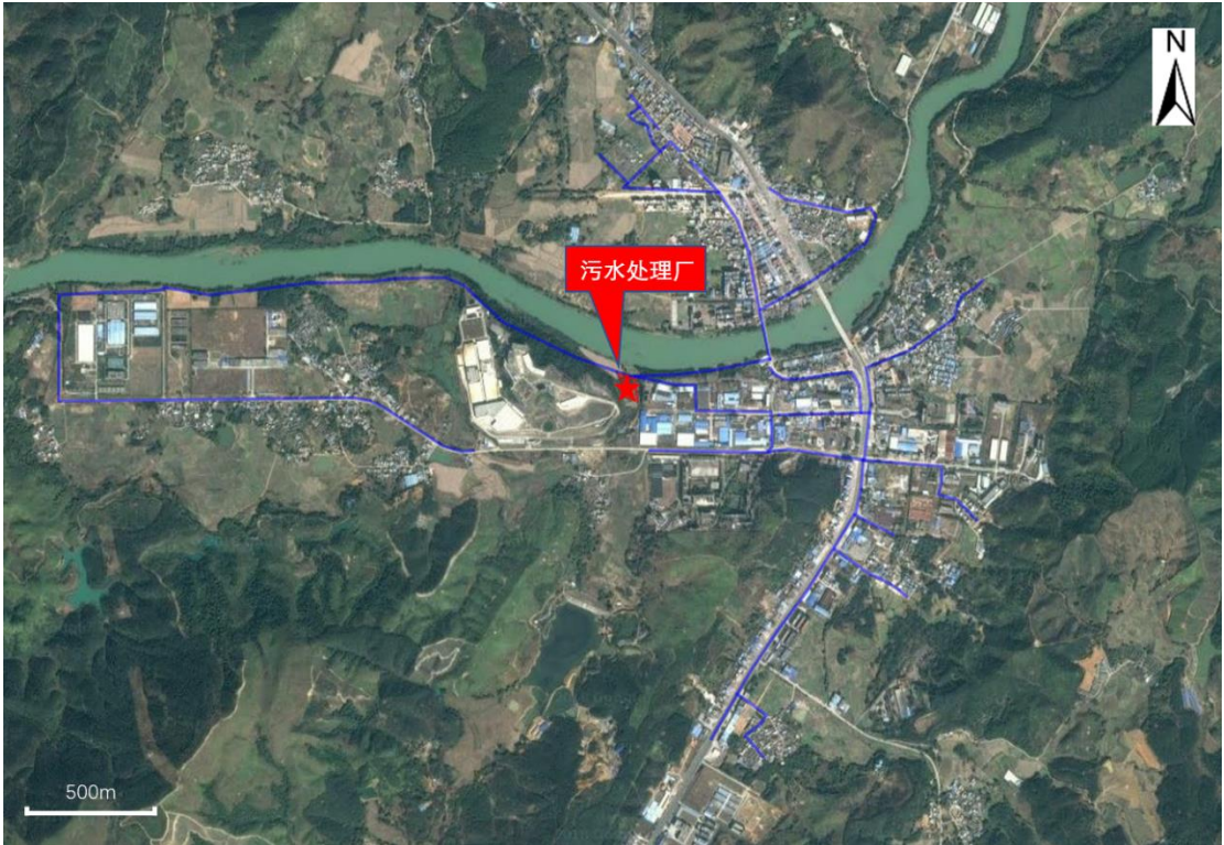
图 2 污水厂位置及管道铺设示意图
