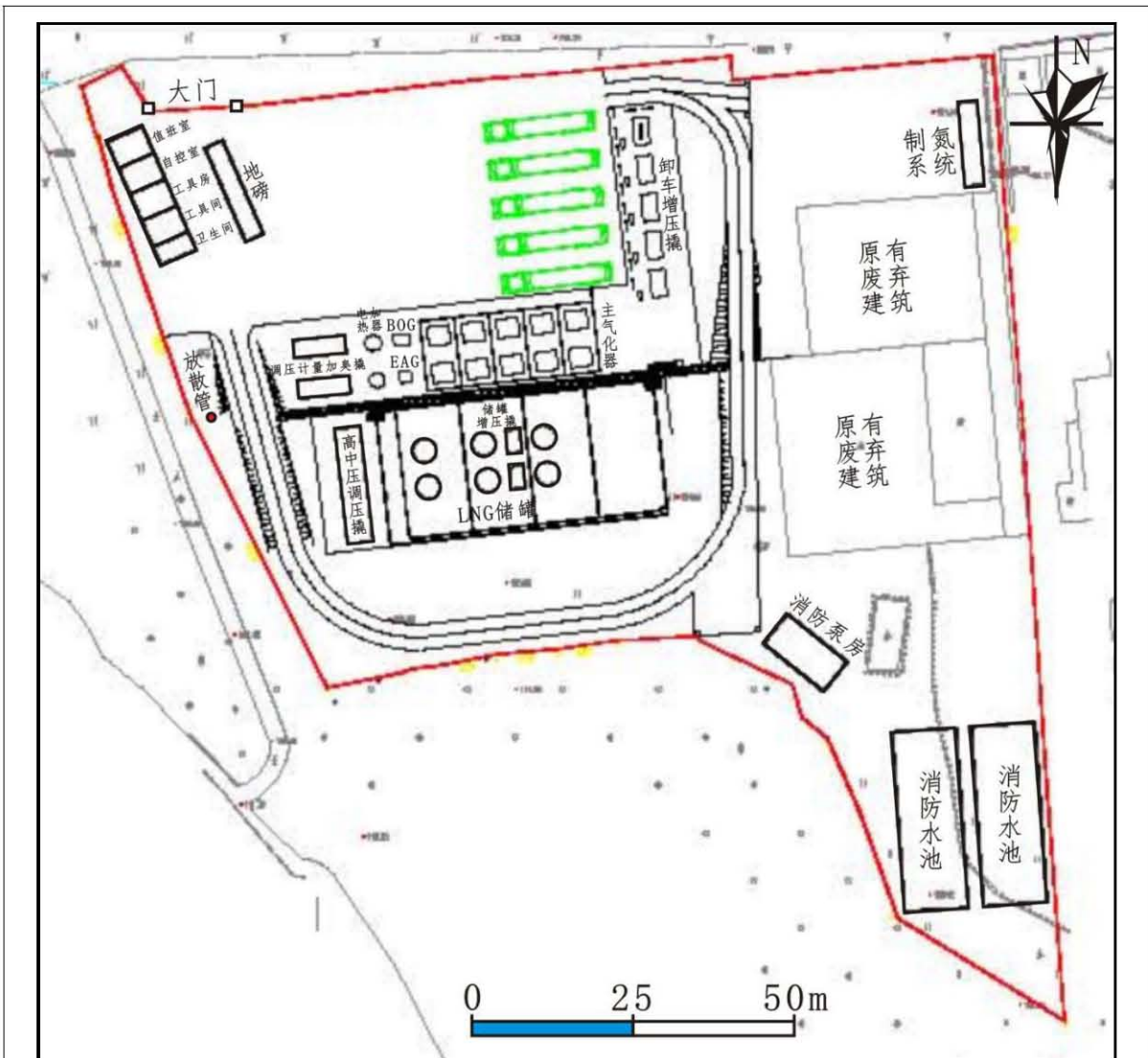
图 2 气化站平面布置图
