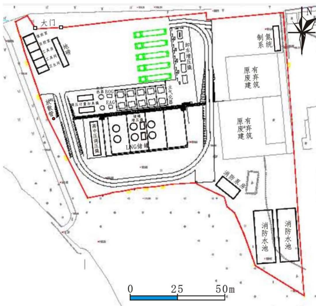
图 4-2 气化站平面布置图
