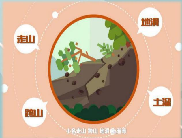
成因特征：①坡体内含有易滑层和软弱夹层；②当岩层的倾向和斜坡的坡面倾向一致，且倾角小于坡角；③坡体下陡中缓；④滑带土在地下水的浸润下抗剪强度降低。
