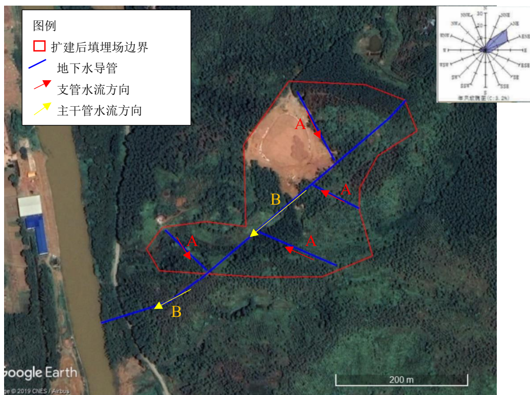
图 3.2-15 地下水收集导排系统
