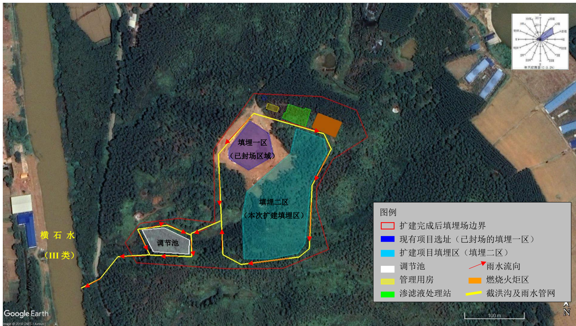
图 3.2-7 项目雨水管网图
