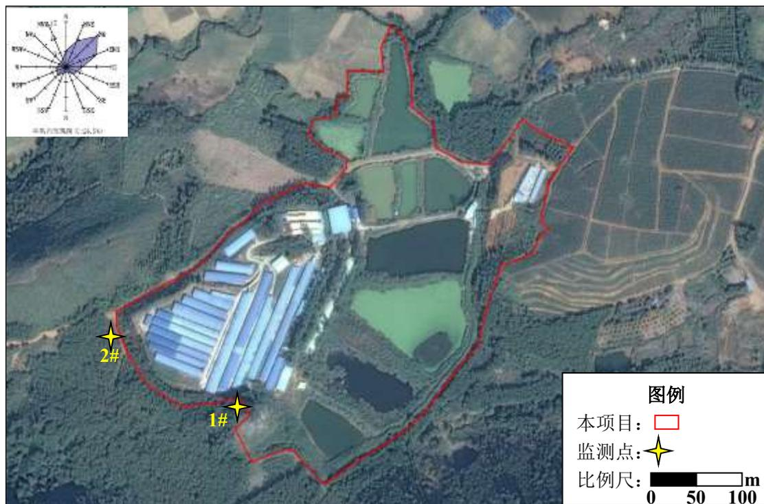
图 3.1-6 无组织废气监测布点图
