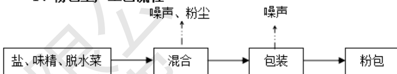
图7 粉包生产工艺流程及产污环节图
