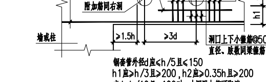
图9.4.17b 梁水平留洞尺寸限值与构造
