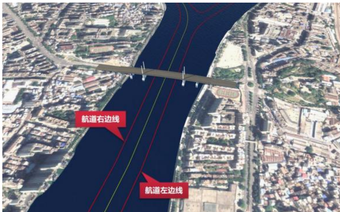
图2.5-2 北江大桥桥区航道线路图
