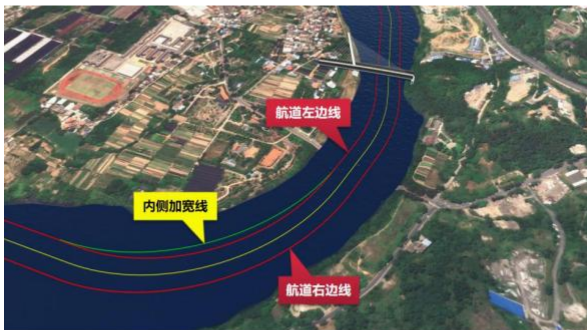
图2.5-6 十里亭大桥桥区航道线路图
