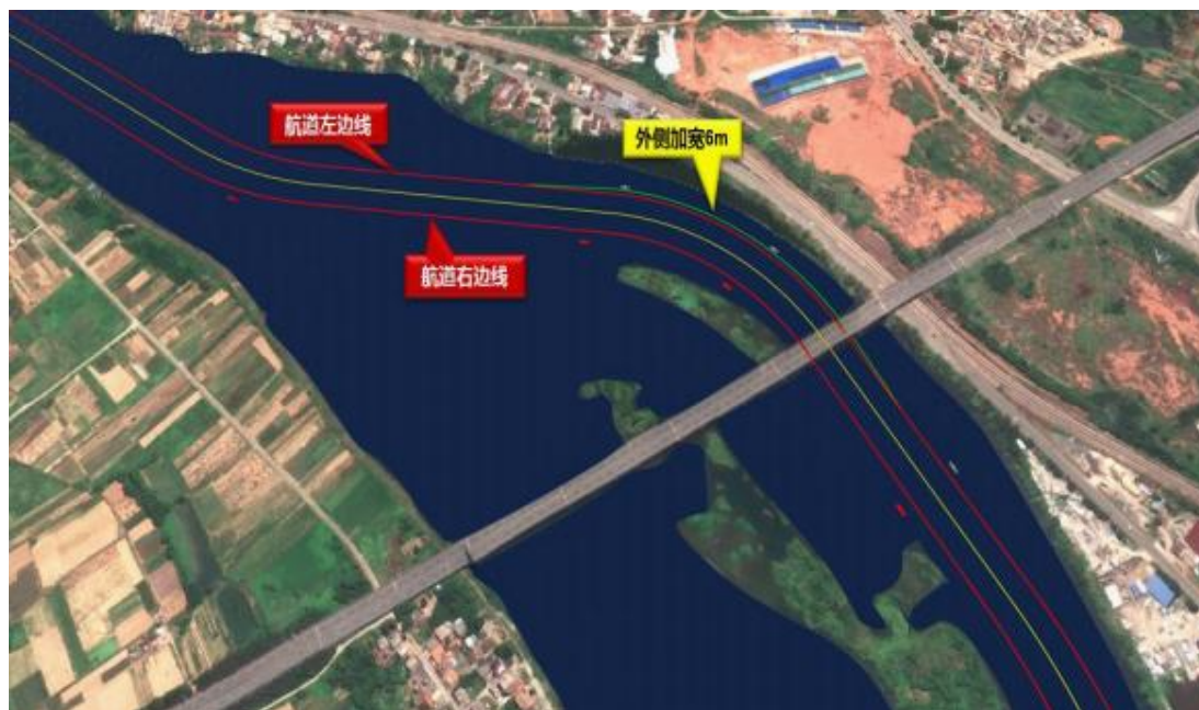
图2.5-7 广乐高速大桥桥区航道线路图
