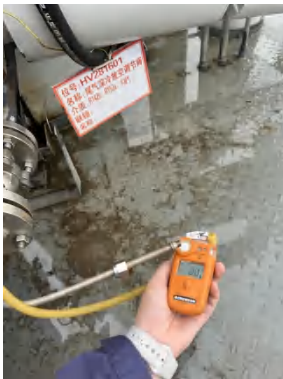
图 3.1-8 装置中不凝气的氯气实测结果
