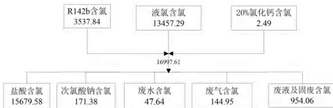
图 4.8-8 本项目氯平衡图 (单位: t/a)
