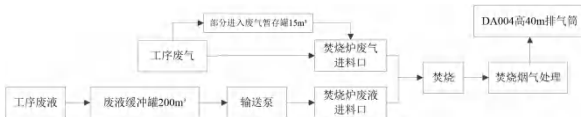
图 7.2-3 焚烧物料进料工艺流程示意图
