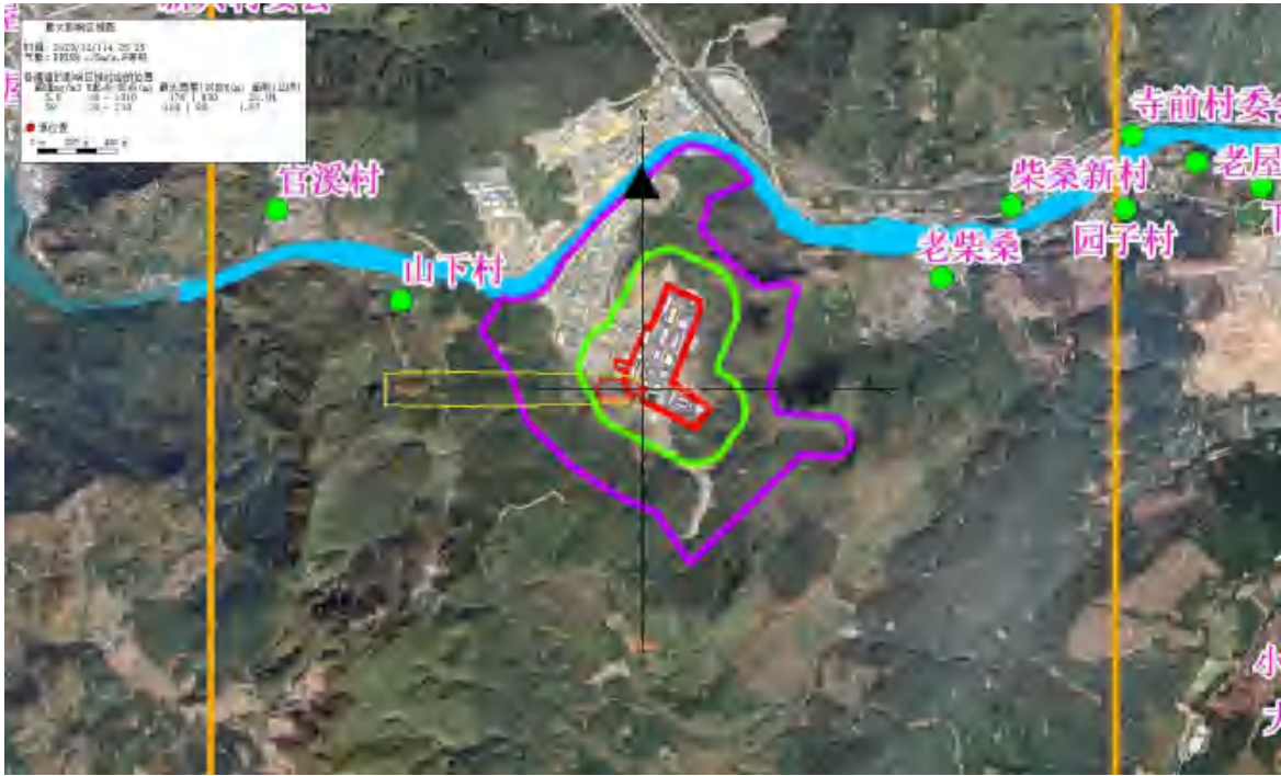
图 6.8-1 最不利气相条件下氯气泄漏 10 分钟超过阈值的最大轮廓线图形
