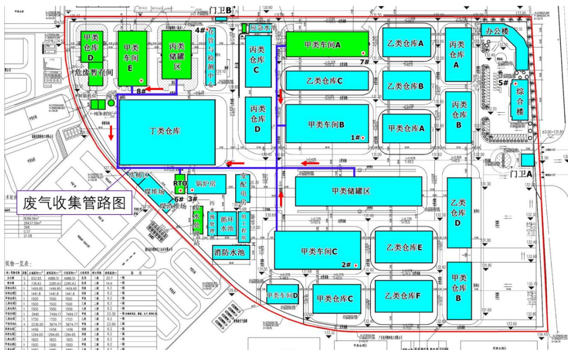
图 4.6-2 有机废气收集管路图
