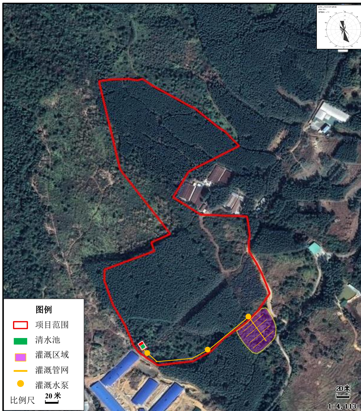
图 8.2-2 本项目尾水回用灌溉管网图
