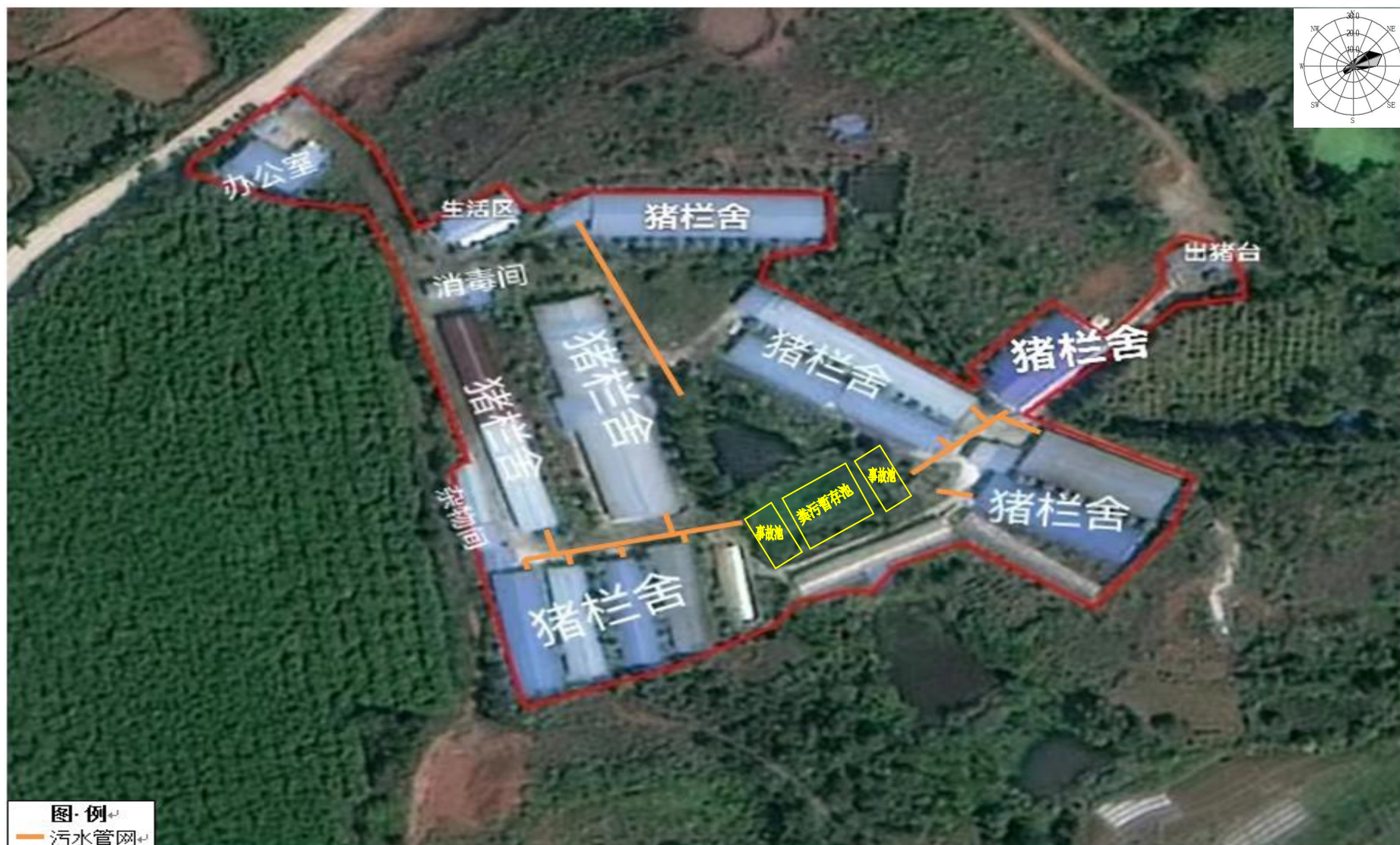
附图 12 项目污水管网图
