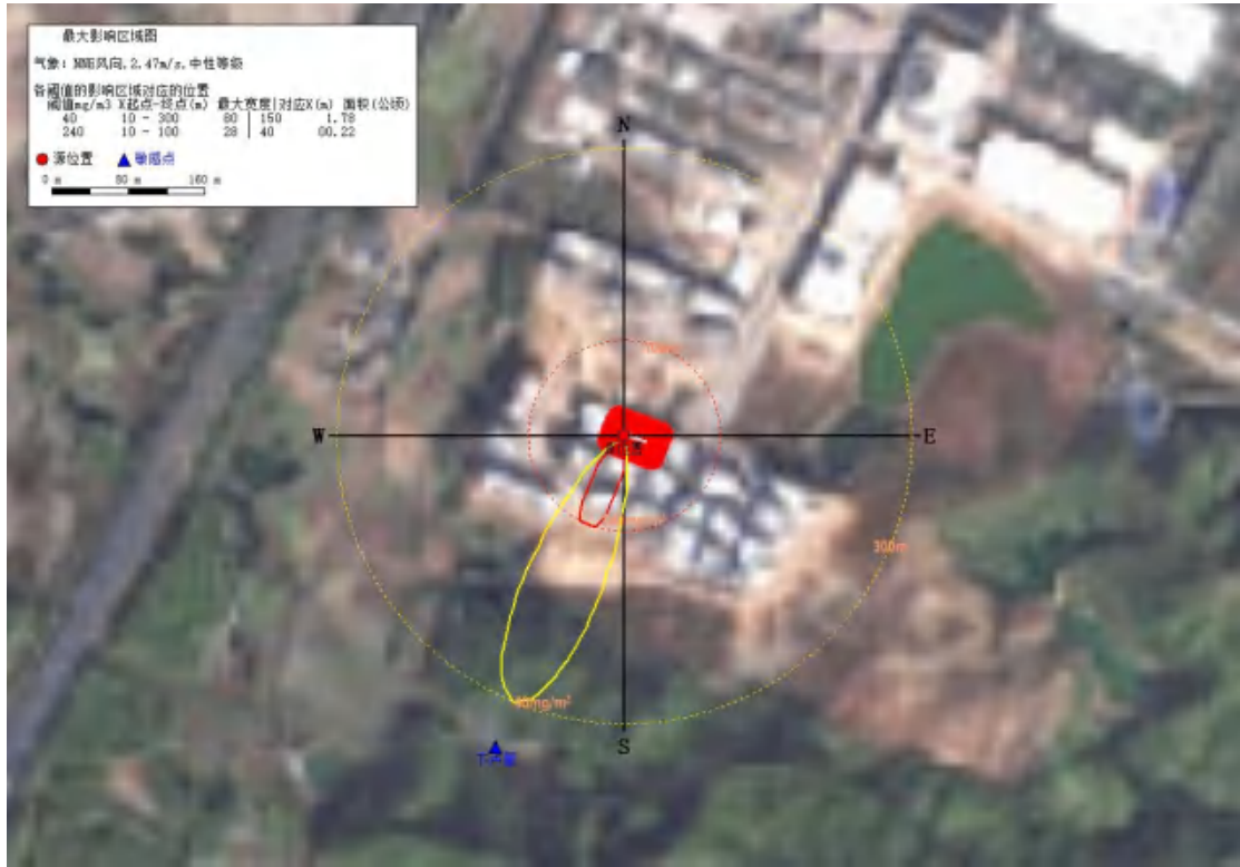
图6.4-1 常见气象条件下MDI浓度超过阈值范围的最大影响范围图
