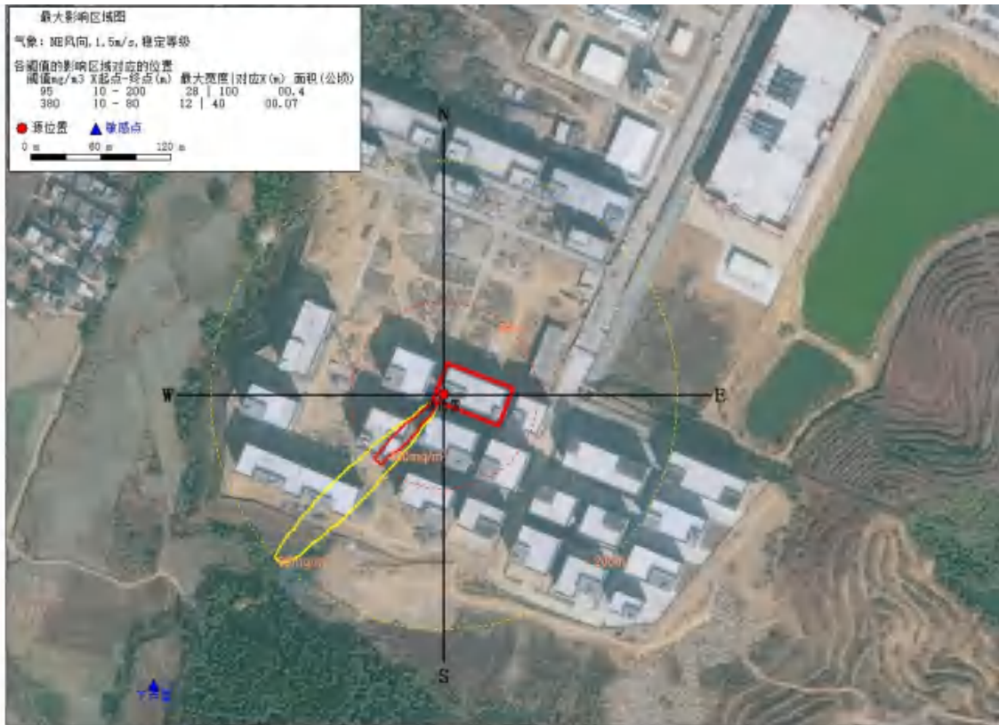
图 6.4-4 不利气象条件下 CO 浓度超过阈值范围的最大影响范围图
