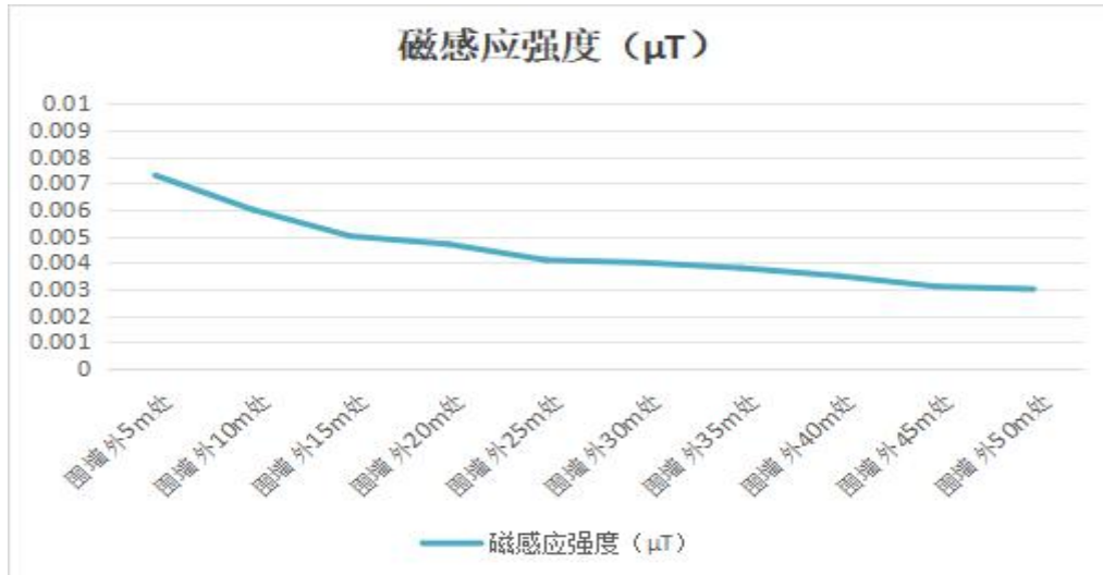
图 I-8-3 110 千伏福和站监测断面磁感应强度趋势图
