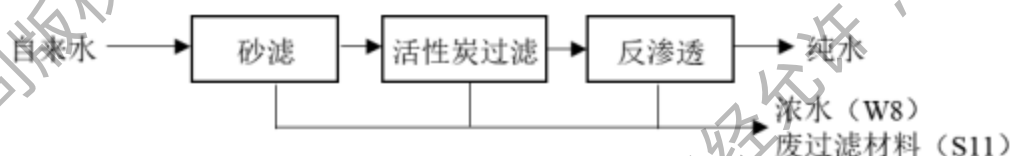
图 2.4-9 项目纯水制备工艺流程图
