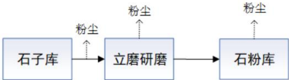
图 2-4 在建项目石子生产工艺流程图
