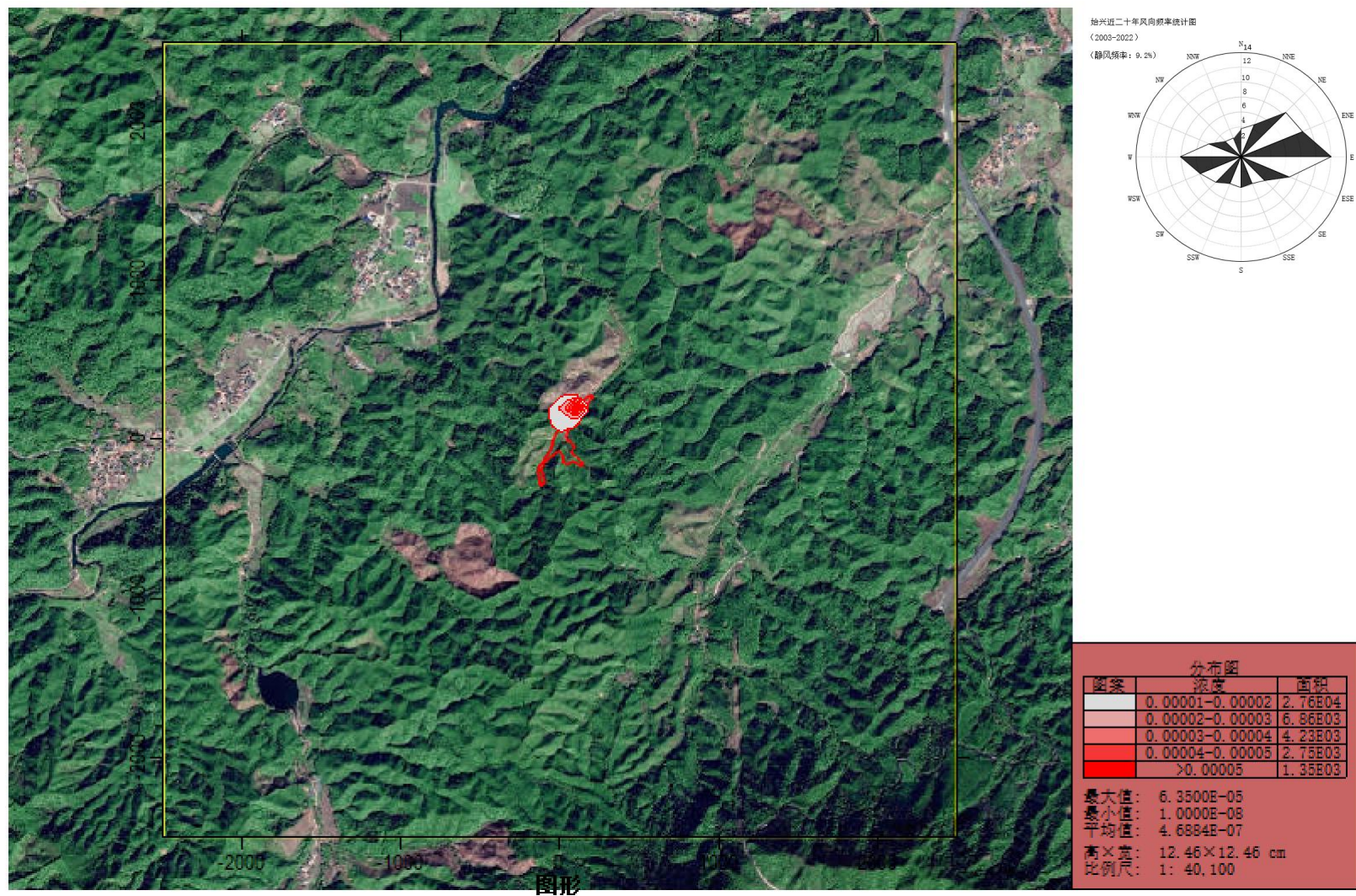
图 5.2-16 正常排放 \text{PM}_{10} 年均浓度各点贡献值分布图 ( \text{mg}/\text{m}^3 )
