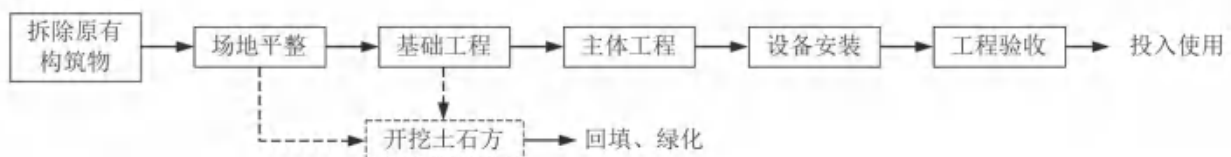
图3.3.1-1 项目猪场区域建设施工期工艺流程及产污位置示意图
