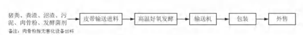
图3.3.2-3 项目有机肥加工工艺流程图
