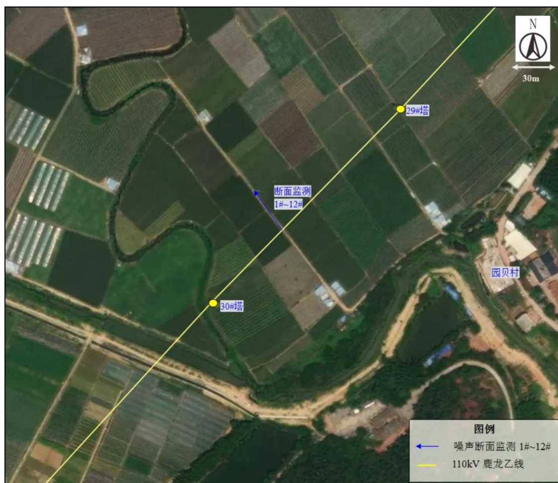
图4.9-2 惠州110kV鹿龙乙线同塔双回架空线路布点示意图
