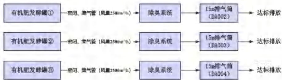
图3.4.2-2 有机肥发酵恶臭气体收集及处置措施流程图
