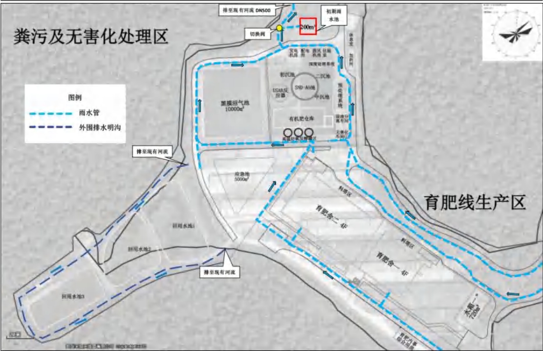
图7.2.2-5 粪污处理区雨水管网图
