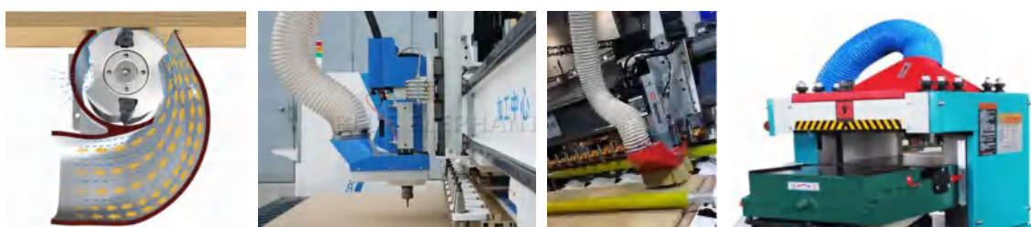
木工机械吸尘设计示意图
