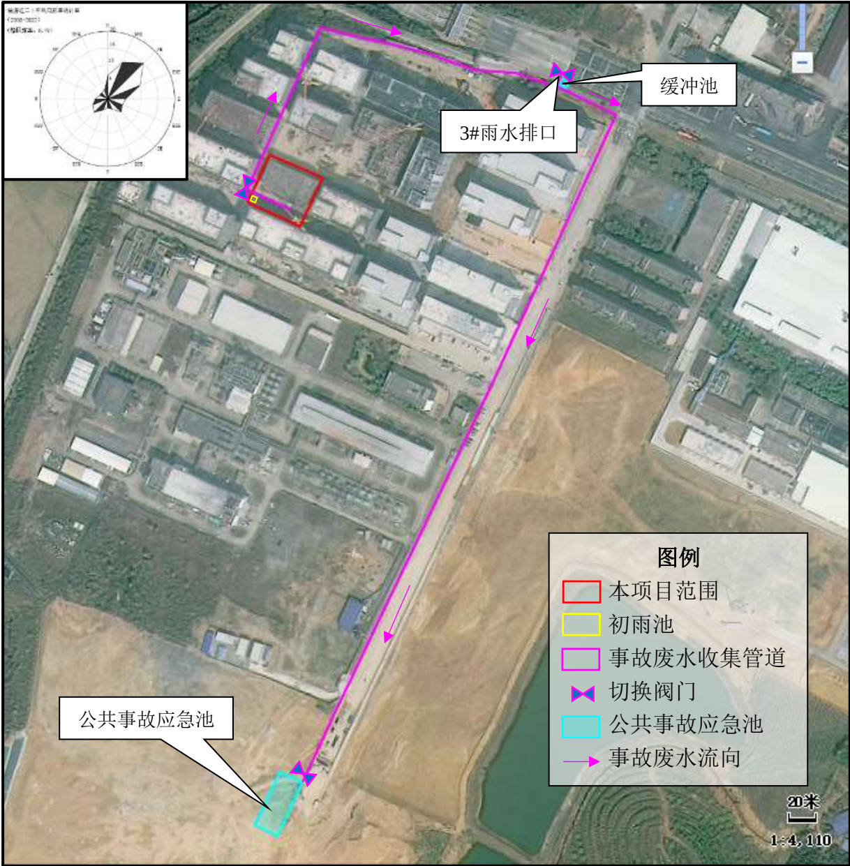
图9.6-1 本项目事故废水控制、封堵系统图
