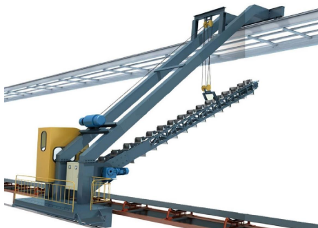
图3.9-11 半桥式刮板取料机
