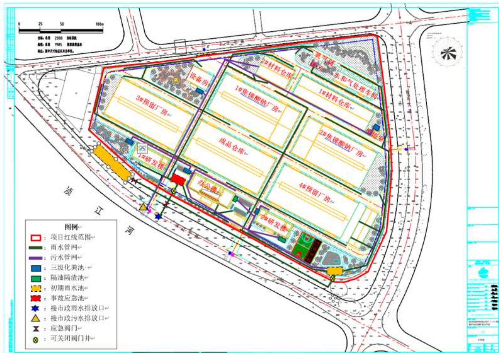
图 3.2-2 项目厂区雨污管网图
