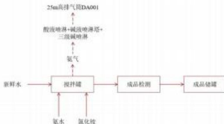
图 3.2.2-2 碱性蚀刻液补充液生产工艺流程及产污环节
