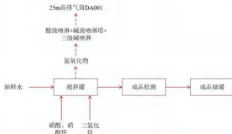
图 3.2.2-3 退锡水生产工艺流程及产污环节
