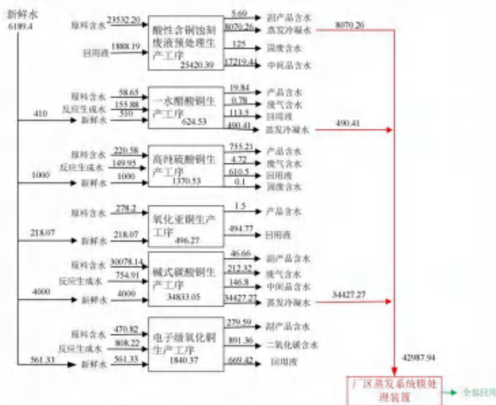
图4.5-16 含铜蚀刻废液综合利用生产线水平衡图 (m³/a)
