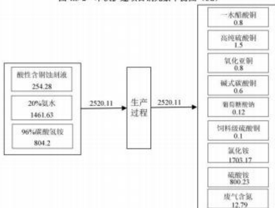
图 4.5-3 本次扩建项目氮元素平衡图 (t/a)
