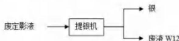
图 3.2.1-14 废定影液综合利用工艺流程及产污环节
