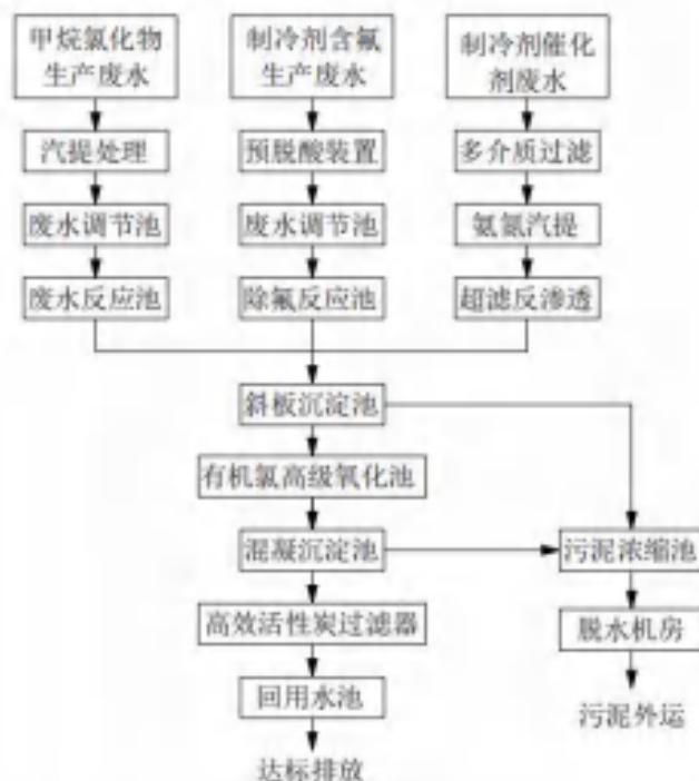
图 5.2-6 氟有限废水处理站处理工艺流程图
