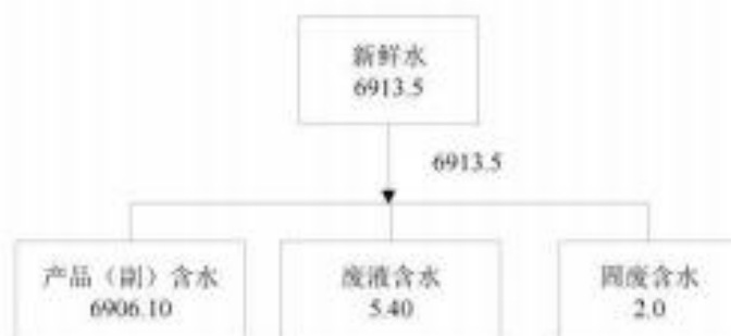
图 4.8-6 VDF 装置升级改造后水平衡图 (单位: m³/a)
