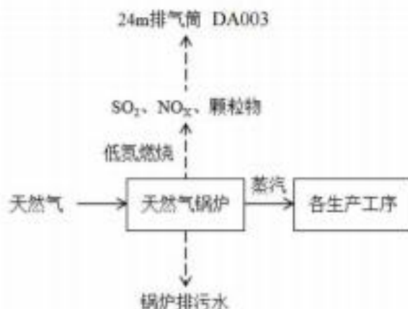
图 3.2-2 锅炉生产工艺流程图
