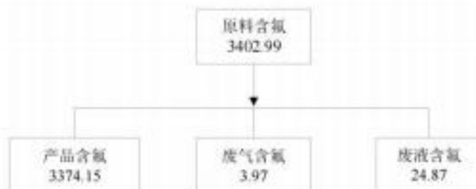
图 4.8-8 VDF 装置升级改造后氟平衡图 (单位: t/a)
