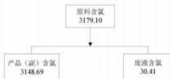
图 4.8-7 VDF 装置升级改造后氯平衡图 (单位: t/a)
