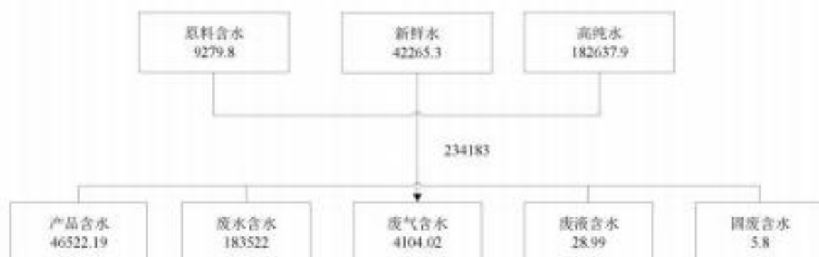
图 3.1-7 已验收投产项目工艺水平衡图 (单位: m³/a)
