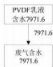
图 4.8-10 后处理喷雾干燥生产工序水平衡图 (单位: \text{m}^3/\text{a} )
