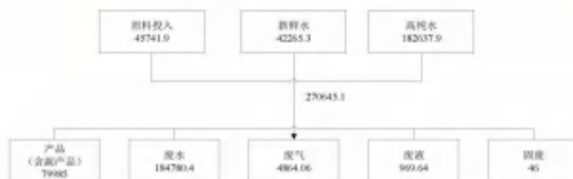
图 3.1-6 已验收投产项目总物料平衡图 (单位: t/a)
