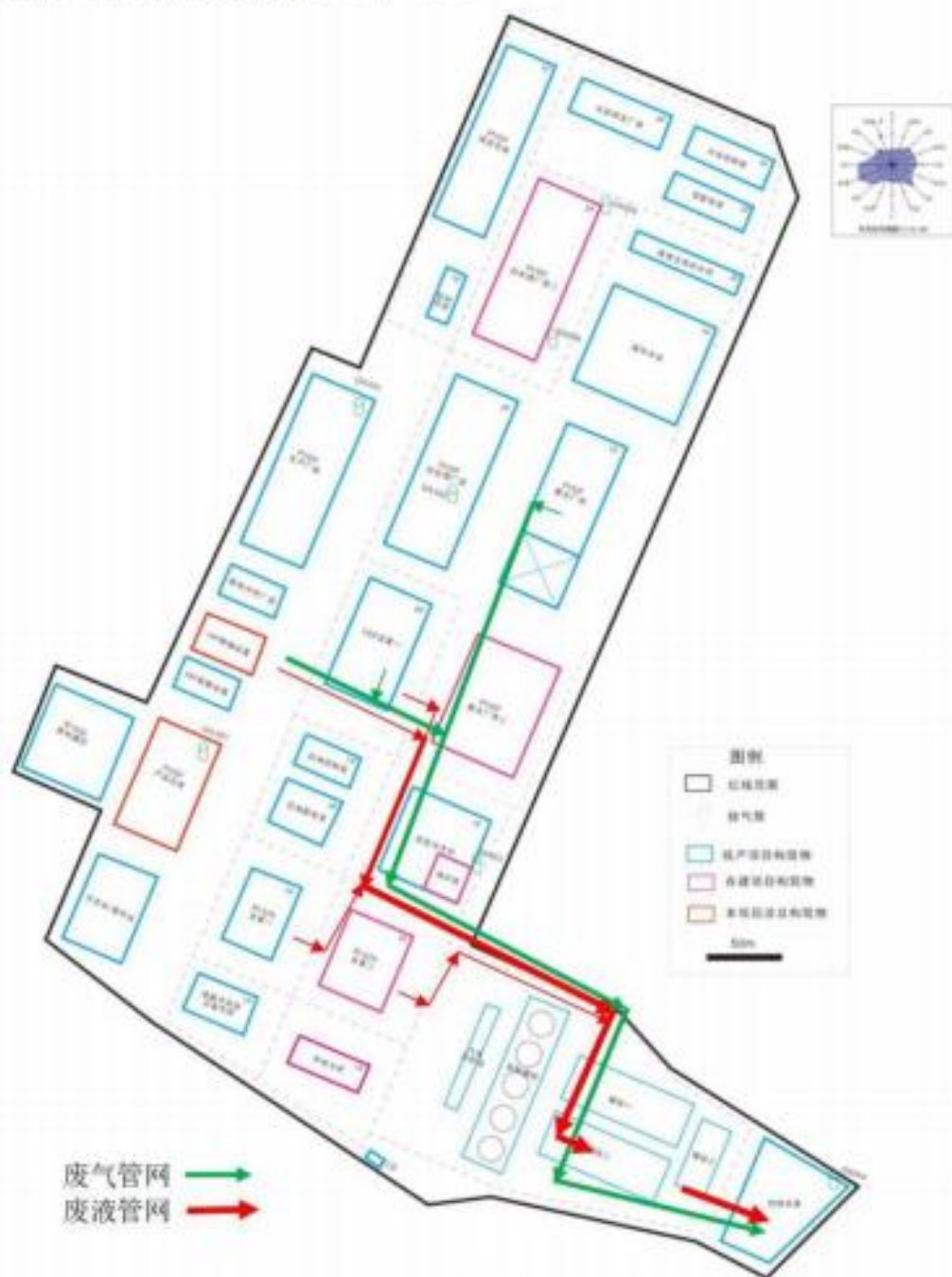
图 7.2-3b 焚烧物料进料管道示意图
