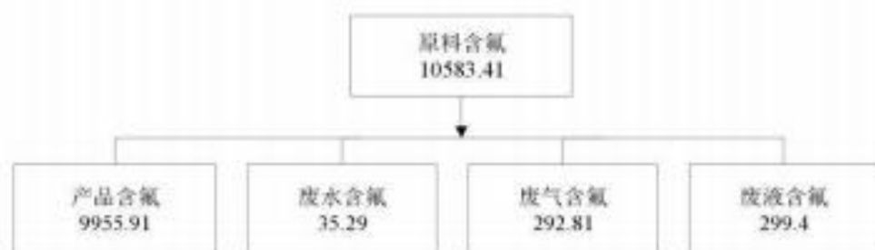
图 3.1-9 已验收投产项目氟平衡图 (单位: t/a)
