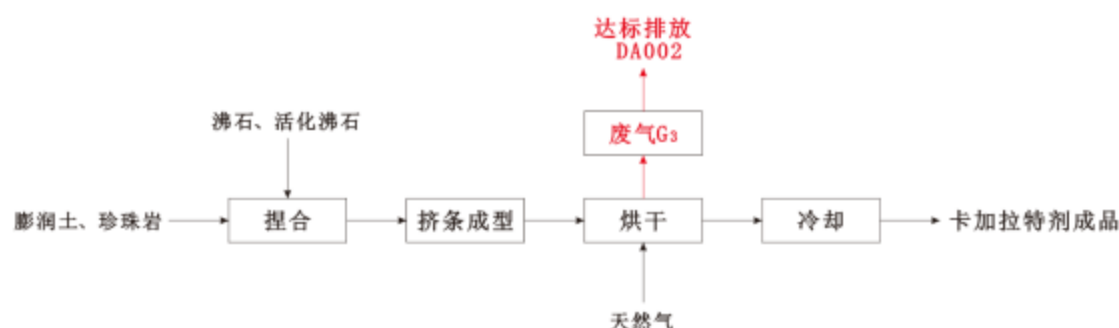
图 3.4-2 卡加拉特剂生产工艺流程及产污节点图
