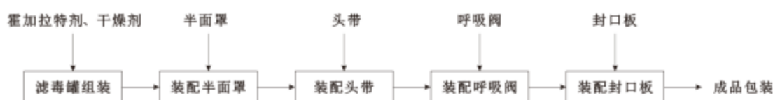
图 3.4-3 过滤式消防自救呼吸器生产工艺流程及产污节点图
