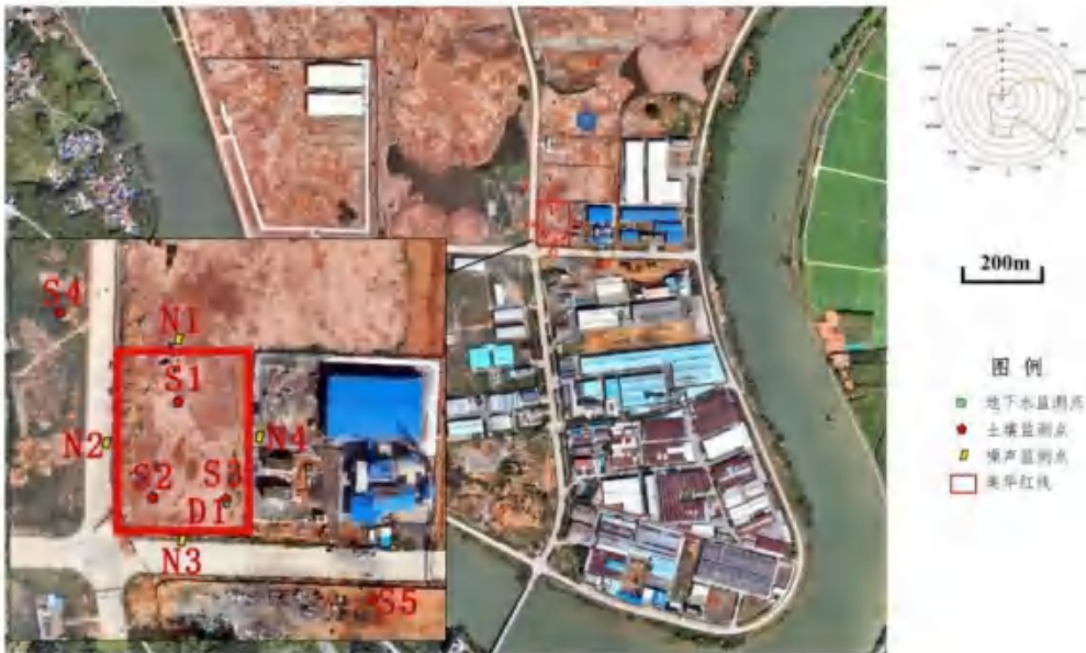
图 3.2-2 噪声、地下水和土壤现状监测布点图
