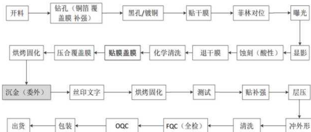
图 2-22 双面柔性板生产工艺流程
