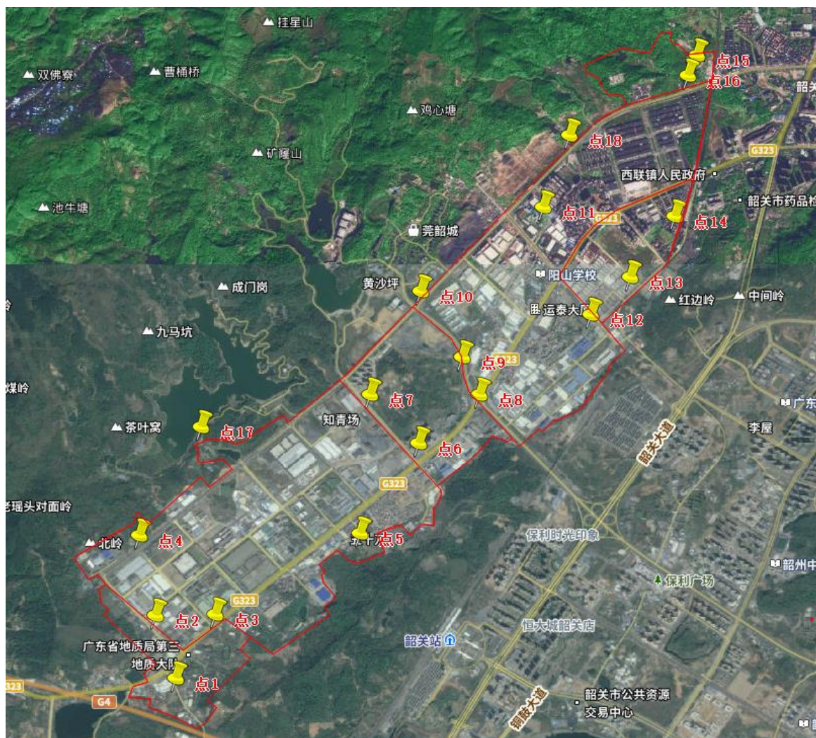
图 3-2 韶关高新区沐溪-阳山片区土壤电阻率测点位置图
