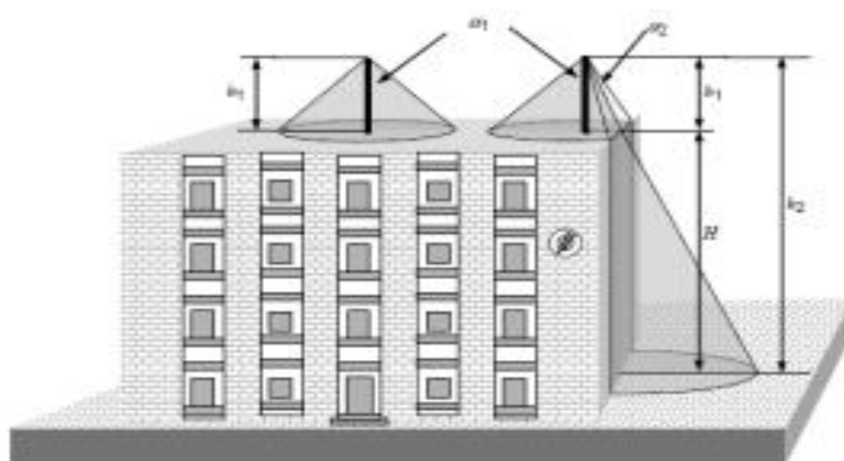
H ——建筑物离参考平面的高度 h_1 ——为接闪接闪针的物理高度 h_2 —— h_1+H 为接闪接闪针离地面高度 \alpha_1 ——高度 h=h_1 时的保护角 h 为屋顶表面与参考平面的高度 \alpha_2 ——高度为 h_2 的保护角
