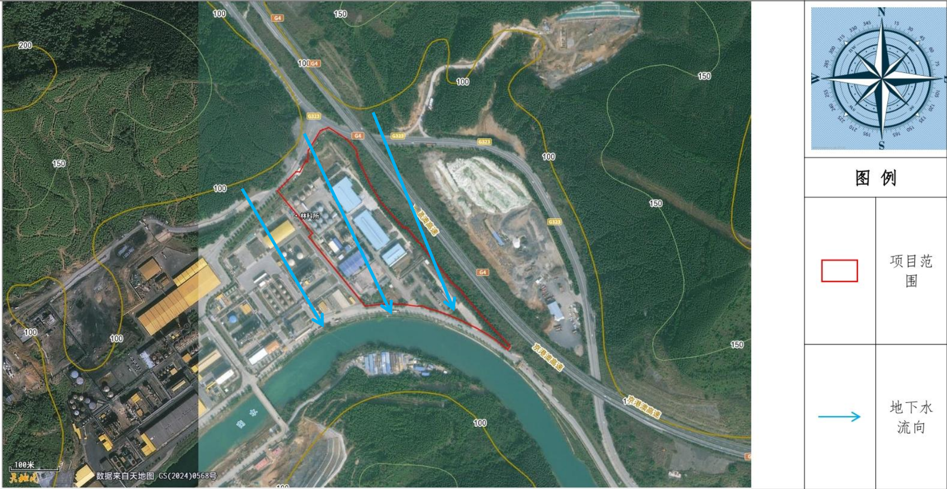
图 5-9 地下水等高线及地下水流向图
