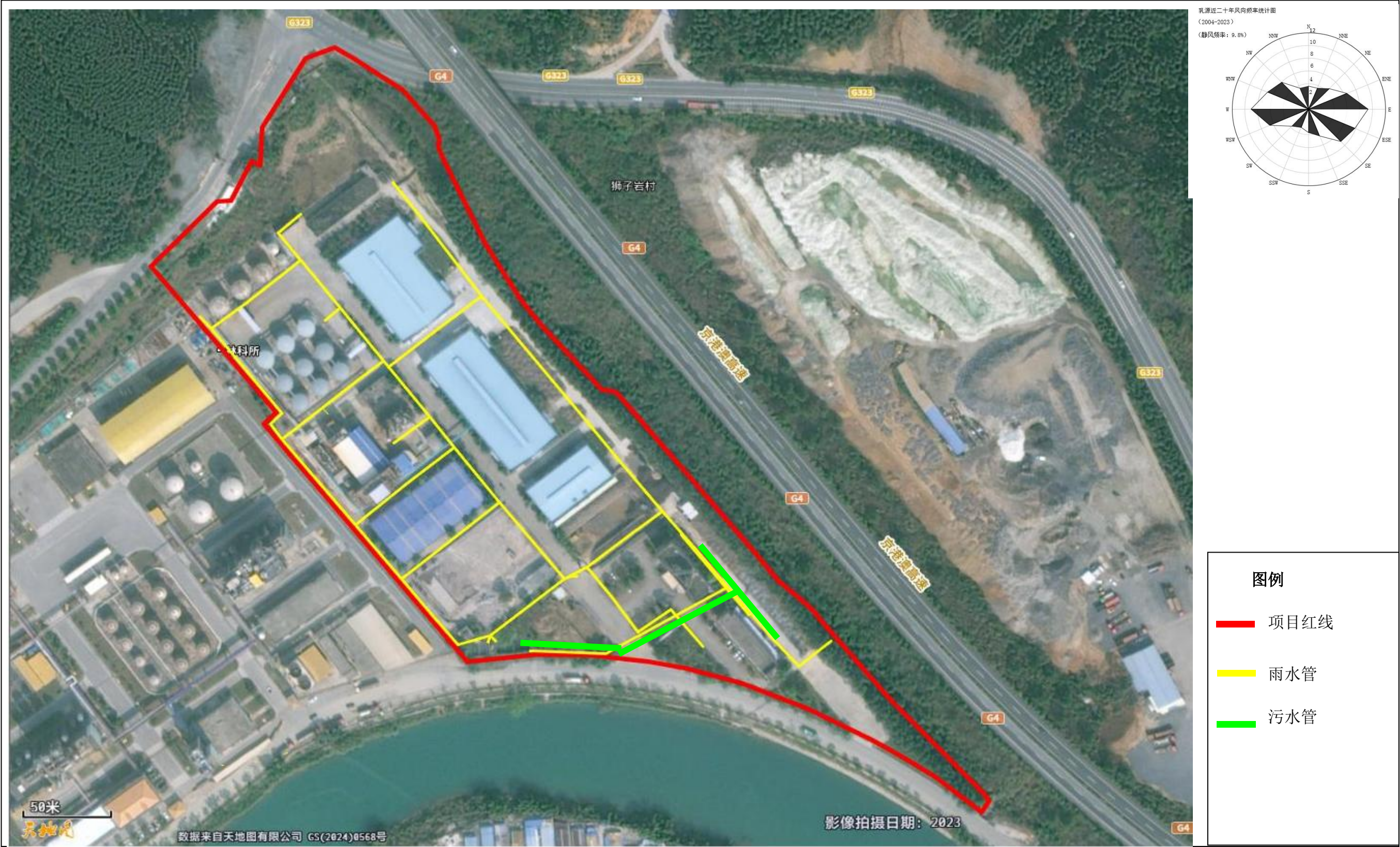
图 4-5 本项目雨污管网图
