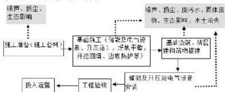
图2 项目施工期施工流程图
