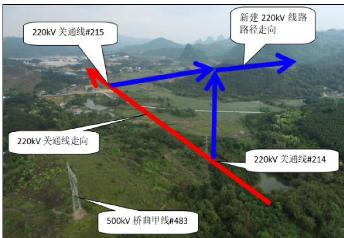
图 2-6 220kV 关通线#214、#215 塔解口点
